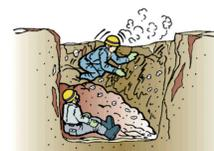
1.5m以上掘削は⇒土止め先行工法若しくは45°以下の安定勾配を確保する
